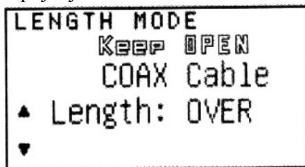
Uložení naměřených hodnot do paměti je stejné jako v režimu LAN. K dispozici jsou 4 paměti.
