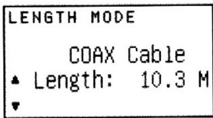
Pokud je kabel ukončen vzdálenou jednotkou, zobrazí se upozornění (keep open) – odpojte jednotku a měřte znovu.
