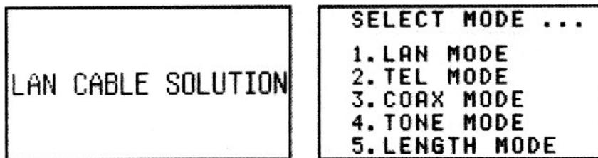
Pomocí tlačítek ▲ a ▼ zvolte testovací mód a potvrďte tlačítkem „TEST“
