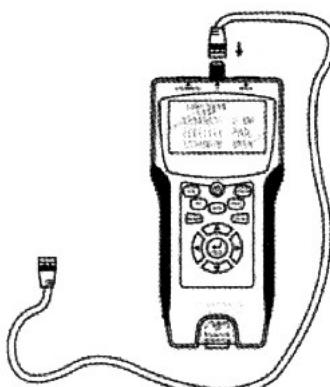
Stiskem tlačítka TEST spusťte test
