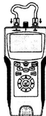
Stiskem tlačítka TEST nebo TEL spusťte test
