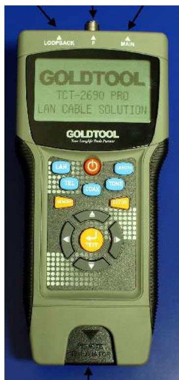
konektor RJ45 na odnímatelné jednotce
